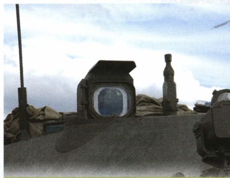
Прицел-прибор командира 1К13-3С на башне «Спрута». Слева от него — антенна радиостанции, справа — датчик ветра.
