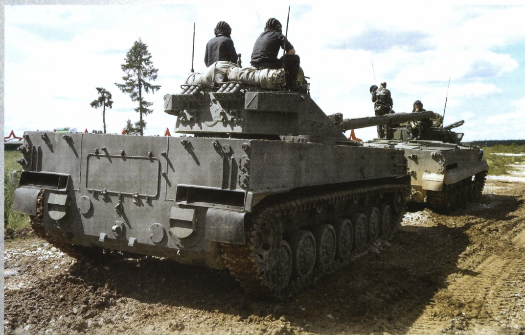
«Спрут-СД» перед началом заезда, Алабино, июнь 2015 года. Хорошо видны выхлопные патрубки и закрытые люки шахт водометных движителей.
